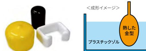
ディップ成形とは、雄型の金型に離型剤を塗布し、予熱した金型をソル中に浸漬した後、ゆっくり引き上げ直ちに加熱炉で加熱させ、冷却、離型する成形方法です。
