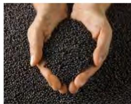
廃プラスチックを検査、粉碎し、お求めの色や物性に合わせて材料をブレンドし、再度検査を行った後、高温で溶かし再生プラスチック原料(再生材)としてペレットに生まれ変わらせます。PP、HDPE、PS、ABS、PCなど各種再生材をご提供可能です。バージン材より低価格で、コストダウンになるとともに循環型社会への貢献にも寄与します。また、廃プラスチックの買取、引き取りもいたします。
