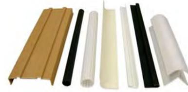
押出成形とは、ホッパから挿入されたペレット状の樹脂を熱で溶かし、スクリューによってシリンダー中に押し込み、可塑性させて、シリンダーの先端に取り付けられたダイから押し出す成形方法です。チューブ状やレール上のものなど、同一形状の製品を連続して成形することができます。
