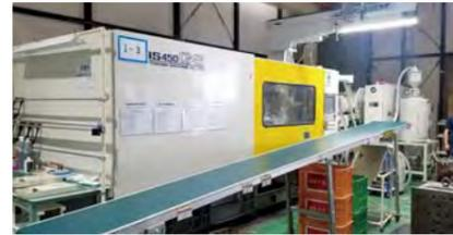
射出成形とは加熱、溶解された材料が射出圧力によってゲートを通して金型へ流し込まれ、冷却・固化させて成形品を得る成形方法です。複雑な形状の製品を大量に生産するのに適していて、最もポピュラーな成形法といえます。
